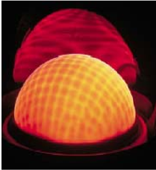
Abbildung 26: Der Matrix-Strahlungsbrenner ist ein Übergang zwischen der flammenlosen Oxidation und der katalytischen Verbrennung;
