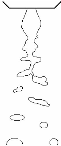
Abbildung 7: Heizölzerstäubung mit einer 0,5-GPH-Düse bei 1,5 bar Zerstäuberdruck.
