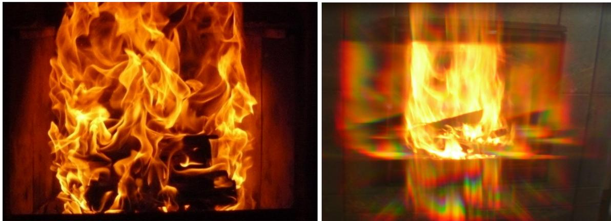
**Bild 7:** Luftzahl zu niedrig ( $\lambda \approx 1,2$ ): rötliche Flammenfärbung, viele dunkle Flächen in der Flamme, starke Rußbildung, Rußbeschlag an der Feuerraumwand, grauer Schornsteinrauch, hohe CO-Konzentration, jedoch mittlerer bis hoher Wirkungsgrad.
