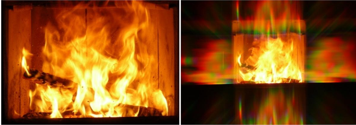
**Bild 9:** Optimale Luftzahl ( $\lambda \approx 2$ ). Halbtransparente, goldgelbe Flamme. Geringe Rußbildung, niedrige bis mittlere CO-Bildung, mittlerer bis hoher Wirkungsgrad.
