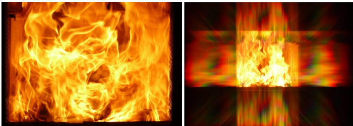
**Bild 8:** Die untere Grenze ( $\lambda \approx 1,5$ ) im optimalen Luftzahlbereich. Schön leuchtende, goldgelbe Flamme. Mittlere bis hohe Rußbildung, niedrige bis mittlere CO-Bildung, hoher Wirkungsgrad.
