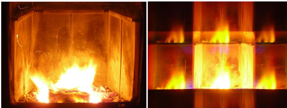
**Bild 11:** Luftzahl viel zu hoch ( $\lambda \approx 5$ ). Keine Rußbildung, über 1 % CO im unverdünnten Abgas, Wirkungsgrad unter 50 %. Entweder sollte Holz nachgelegt werden, oder Primärluft gedrosselt und Sekundärluft geschlossen werden, um in wenigen Minuten die Feuerung zu beenden.
