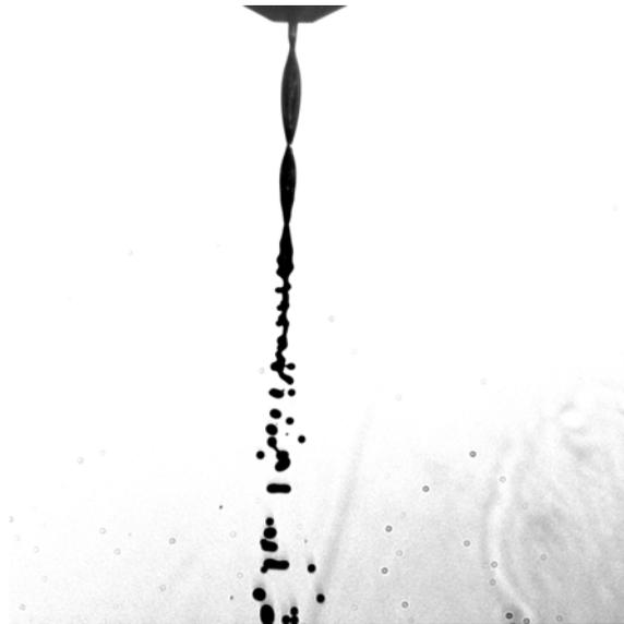
**Abbildung 13:** Sprühbild einer Druckdralldüse ca. 5 – 10 ms nach Brennerschluss.
